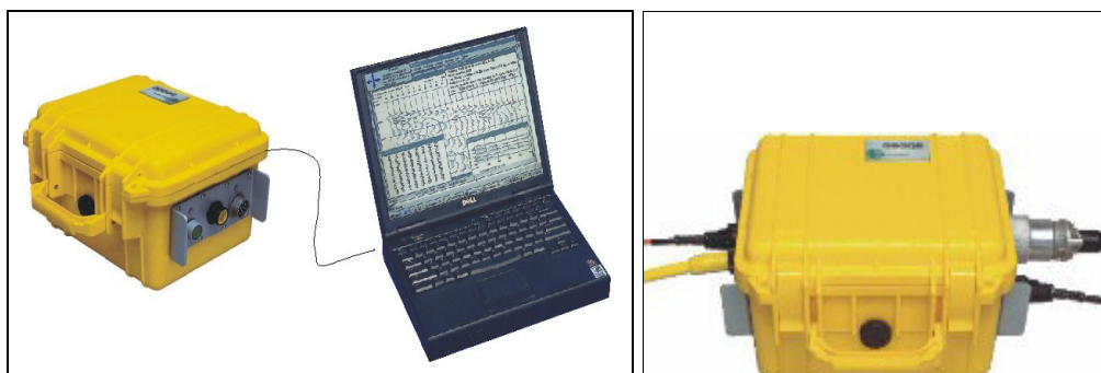
Fig.17-Sismografo geode collegato al pc
