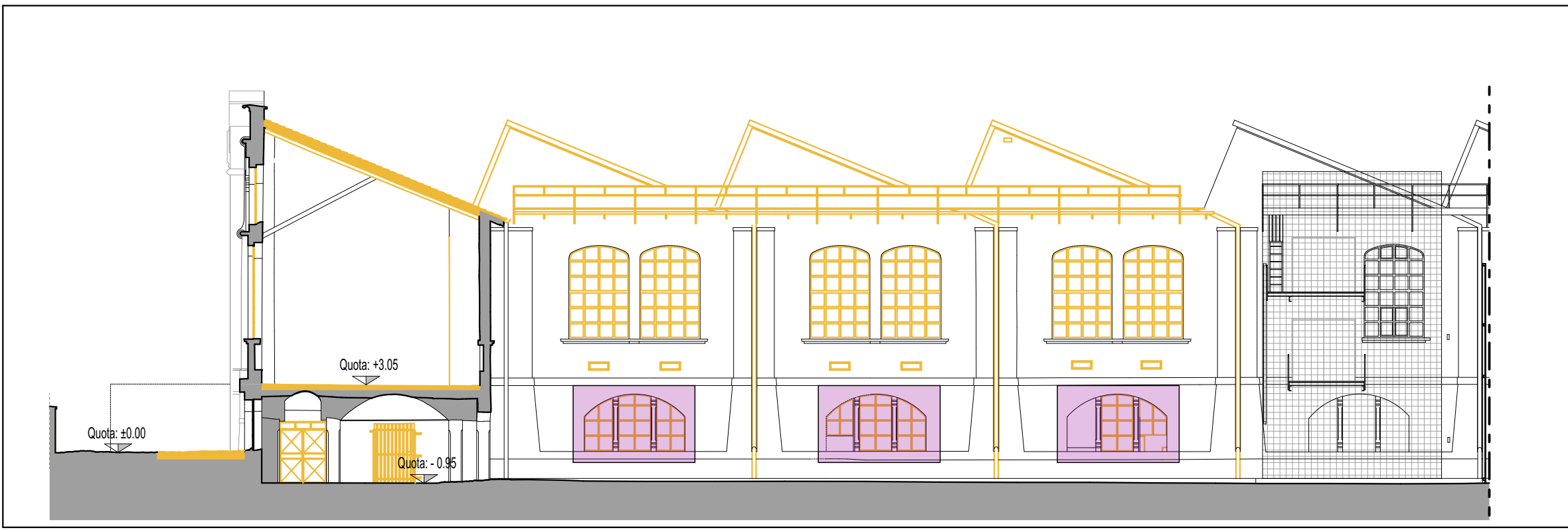
Sezione C-C - prospetto Ovest demolizioni
