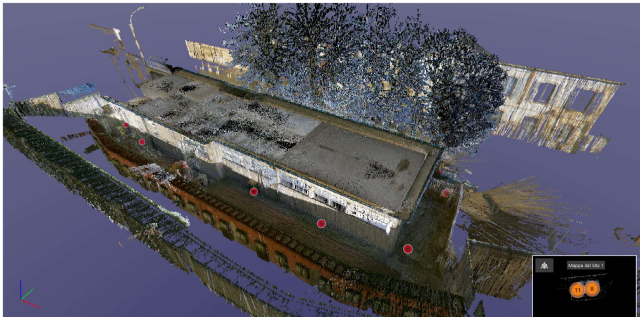
Scansione tramite nuvola di punti dell'edificio esistente
