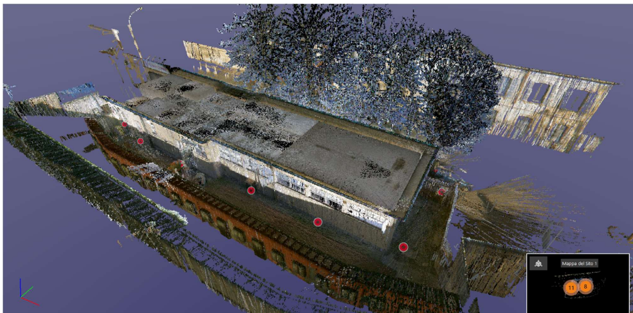
Scansione tramite nuvola di punti dell'edificio esistente
