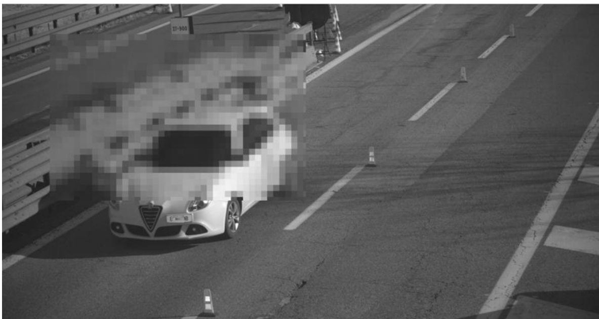
Esempio di mascheramento automatico del parabrezza.
