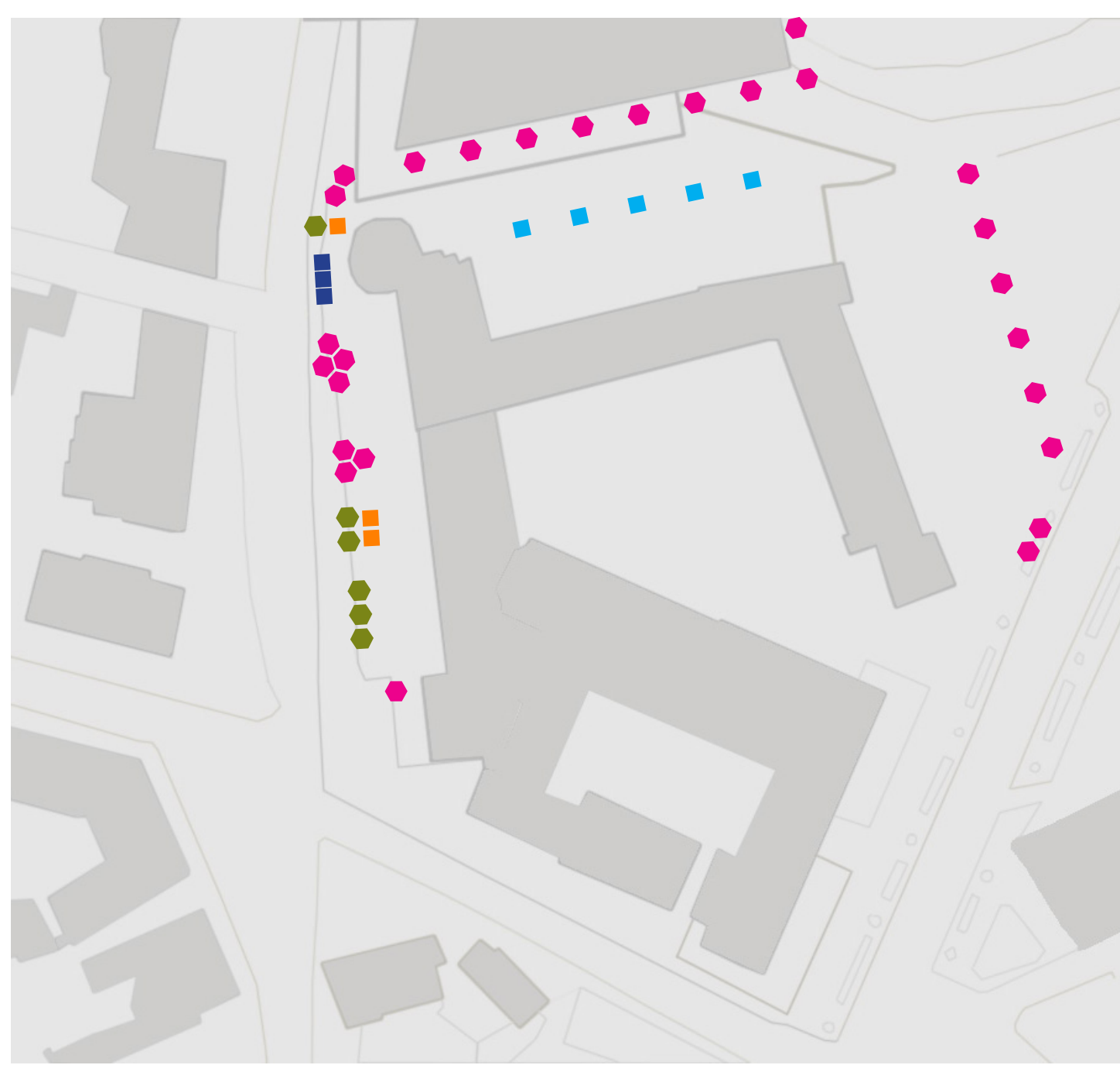
Planimetria apparecchi stato di fatto - Castello Visconteo, Porta Regale, Torrione. ● Apparecchio tipo proiettore per illuminazione architettuale - Porta Regia, Castello e Fossato ● Apparecchio tipo proiettore per illuminazione architettuale - Castello e Torrione ■ Apparecchio tipo proiettore per illuminazione architettuale - Torrione ■ Apparecchio tipo proiettore per illuminazione architettuale - Castello ■ Apparecchio tipo proiettore per illuminazione architettuale - Castello e Fossato
